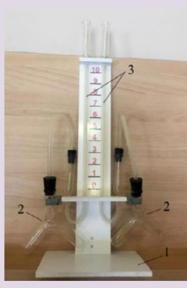
Прибор состоит из подставки, на которой закреплены две манометрические трубы, которые соединяются с сосудами Ландольта с помощью пластиковой трубы с пробками (рис. 5) . Между манометрическими трубками на панели нанесена шкала для наблюдения уровня жидкости в трубках . Окрашенной жидкостью может быть раствор любой красителя в воде .
