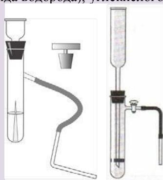
**Рис. 7.** Прибор для получения и сорбирования газов
